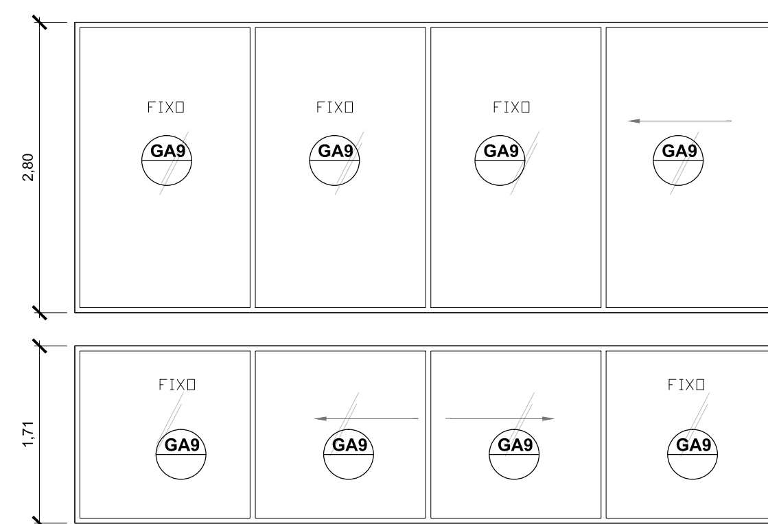
ELEVAÇÃO ESQUADRIA FACHADA SUL esc 1:50
